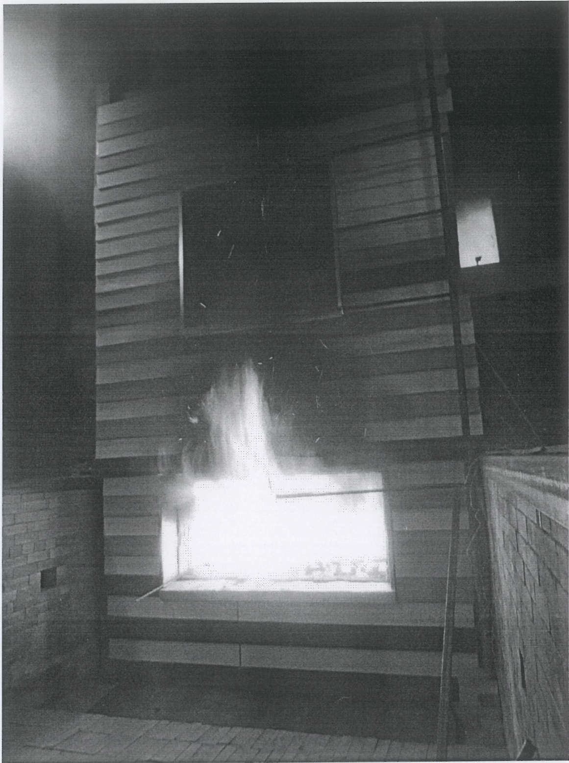
Фото 2. Фрагменты образца фасада при испытании по ГОСТ 31251-2008.
